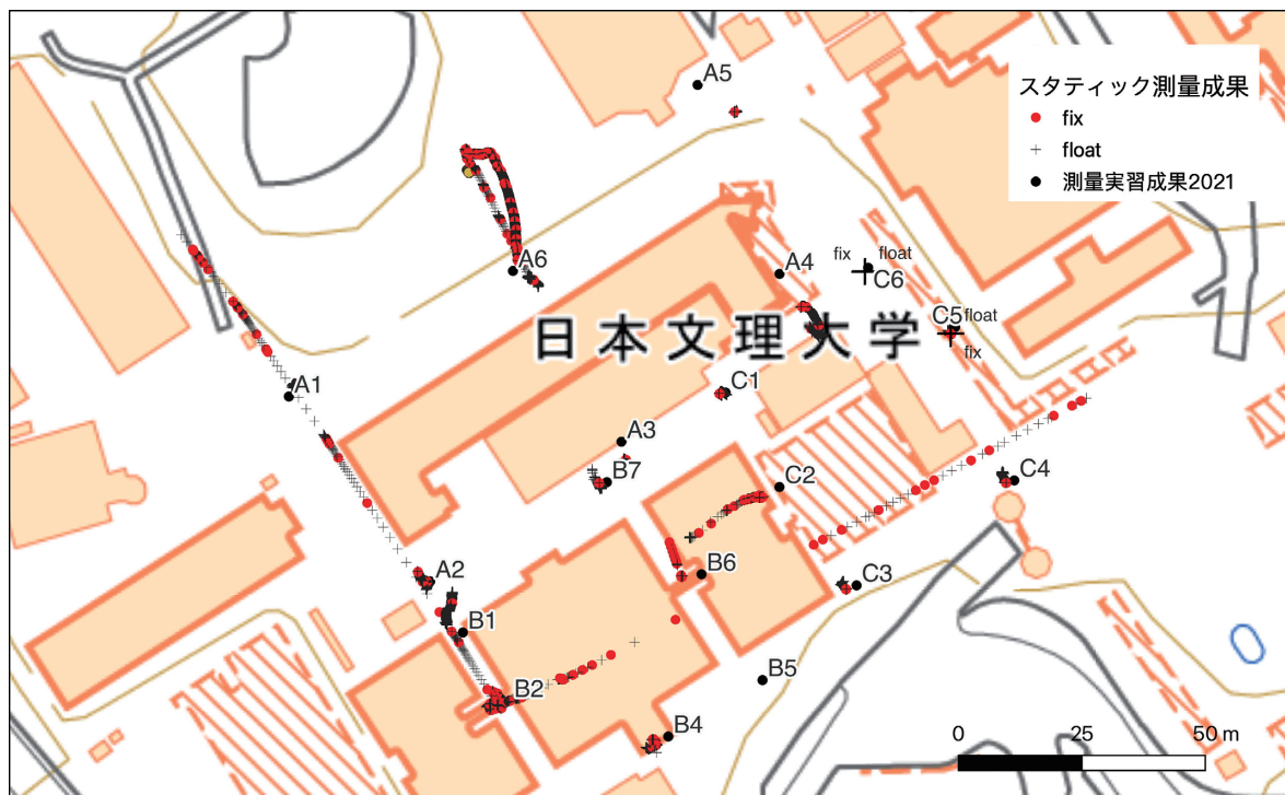
図4. 各測点のFix解及びFloat解の分布（地理院タイルの標準地図に測量結果を記載）
