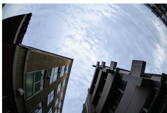
図7. 天空率50.57%となった測点B1の天空写真
