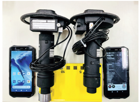
図2. 低コストの Drogger 社製 GNSS 受信機 (円盤部に受信機とアンテナ、円筒部分にバッテリーを内蔵)
