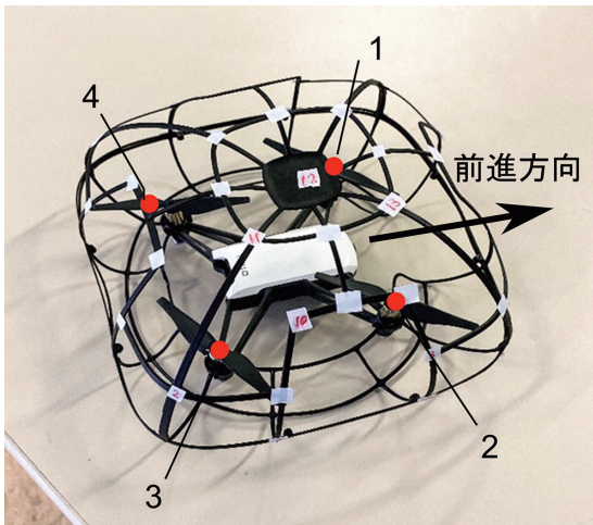
図2. RyzeTech 製小型ドローン Tello および特徴点位置
