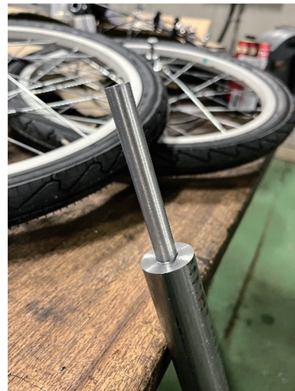
図4. 5 タイヤ取付け部分の加工（片側）
