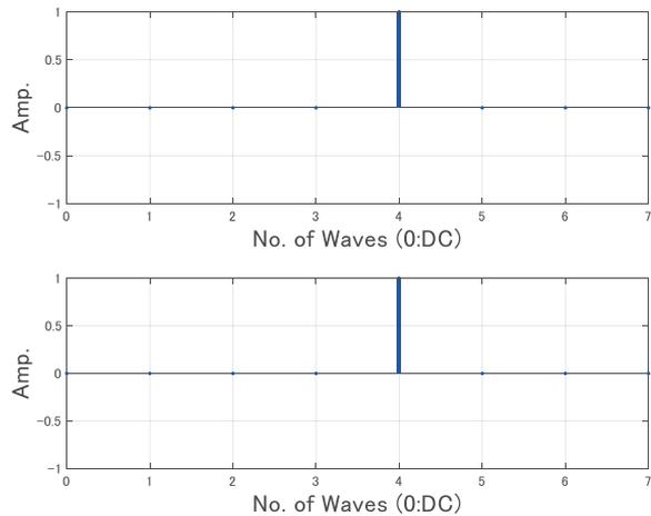
図3 4 Hzの正弦波を512Hz(16倍オーバーサンプリングし連続値に見立てた信号)でサンプリングした際の振幅スペクトル(上段)と32Hzでサンプリングした際の振幅スペクトル(下段)
