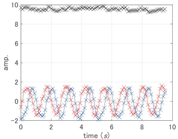
図18 スマートフォンの MatLab Mobile による内蔵3軸加速度センサ計測例
