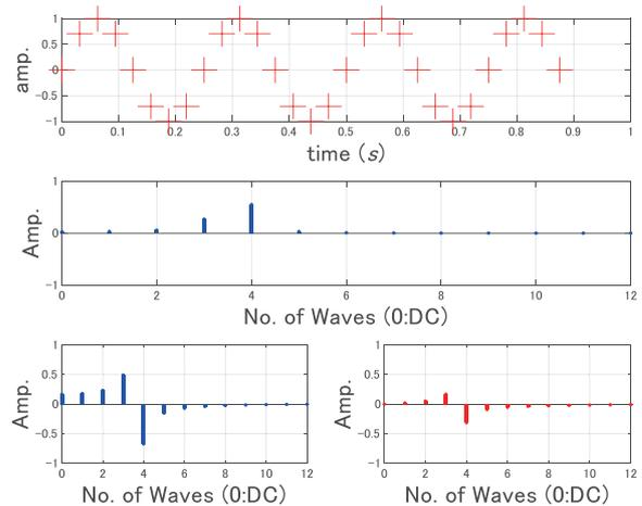
図6 4 Hz の正弦波を32Hz でサンプリングし「29=32-3 サンプル」で分析した際のサンプル値 (上段) 振幅スペクトル (中段) と実数スペクトル (下段左) 虚数スペクトル (下段右)
