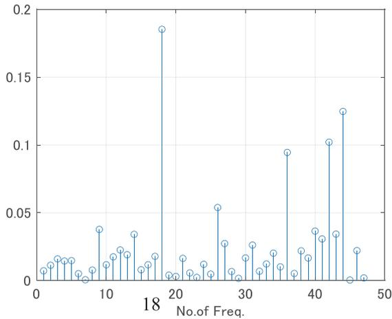
図16 振幅スペクトルピーク値 (図15中段) を時間波形に見立てた振幅スペクトル
