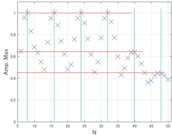
図7 分析に使用するサンプル数  $N$  を6から50に変化させた時の振幅スペクトルピーク値の変化 ( $f = 4 \text{ Hz}$ , サンプル値の総数は32個とし33サンプル目以降の値は0)
