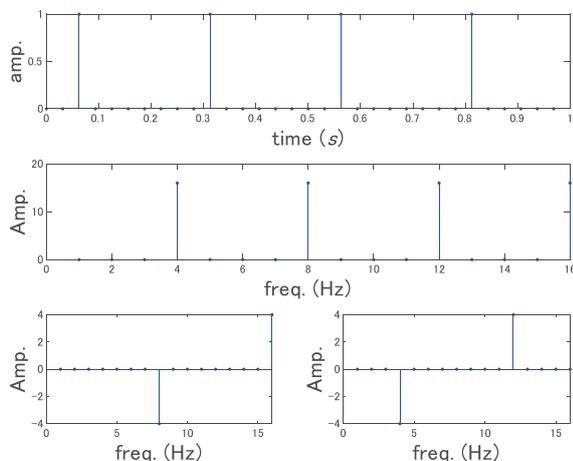
図11  $f = 4 \text{ Hz}$  の正弦波の波形ピーク値を時間波形（上段）と見立てた時の振幅スペクトル（中段）およびスペクトル実部（下段左）とスペクトル虚部（下段右）
