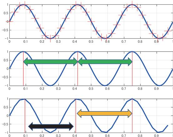
図2 3 Hzの正弦波と32Hzでサンプルした値の関係
