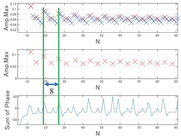
図12  $f = 4 \text{ Hz}$  のピーク値で構成したパルス列において分析区間長  $N$  を6から96に変化させた時の振幅スペクトルピーク値の変化とピーク値（上段）、ピーク値（中段）、位相スペクトル累計値（下段）
