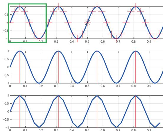
図1 4 Hz の正弦波と32 Hz でサンプルした値の関係
