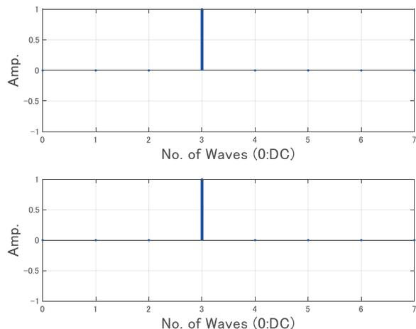
図4 3 Hzの正弦波を512Hz(16倍オーバーサンプリングし連続値に見立てた信号)でサンプリングした際の振幅スペクトル(上段)と32Hzでサンプリングした際の振幅スペクトル(下段)
