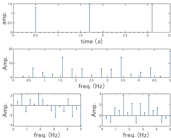
図19 実測 Y 軸加速度波形のピーク値を時間波形(上段)と見立てた時の振幅スペクトル(中段)およびスペクトル実部(下段左)とスペクトル虚部(下段右)
