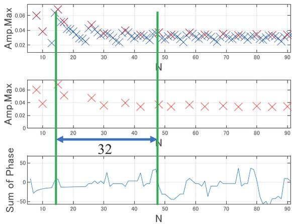
図15  $f = 3 \text{ Hz}$  のピーク値で構成したパルス列において分析区間長  $N$  を 6 から 96 に変化した時の振幅スペクトルピーク値の変化とピーク値 (上段), ピーク値 (中段), 位相スペクトル累計値 (下段)
