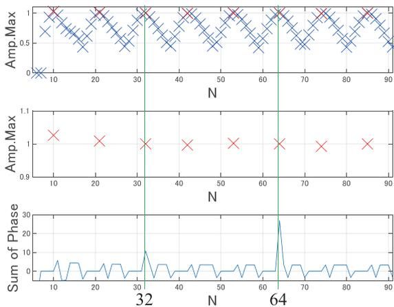
図9  $f=3\text{Hz}$ における分析区間長 $N$ を6から96に変化させた時の振幅スペクトルピーク値の変化とピーク値(上段)、ピーク値(中段)、位相スペクトル累計値
