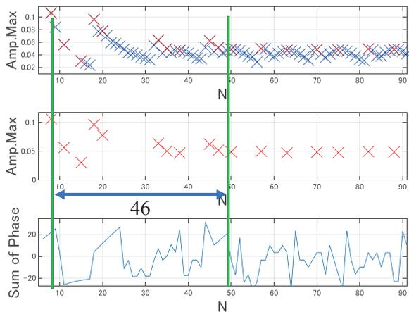
図20 実測 Y 軸加速度波形の振幅ピーク値で構成したパルス列において分析区間長 N を 6 から 96 に変化した時の振幅スペクトルピーク値の変化とピーク値(上段), ピーク値(中段), 位相スペクトル累計値(下段)
