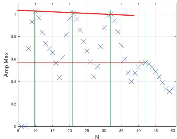
図8 分析に使用するサンプル数 (分析区間長)  $N$  を6から50に変化させた時の振幅スペクトルピーク値の変化 ( $f = 3 \text{ Hz}$ , サンプル値の総数は32個とし33サンプル目以降の値は0)
