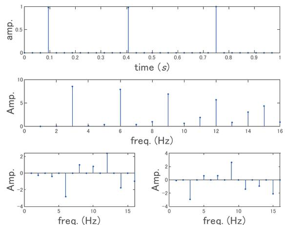
図14  $f = 3 \text{ Hz}$  の正弦波の波形ピーク値を時間波形（上段）と見立てた時の振幅スペクトル（中段）およびスペクトル実部（下段左）とスペクトル虚部（下段右）
