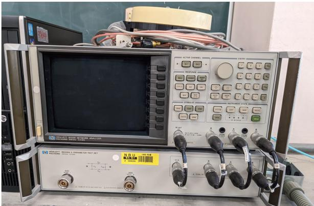
図3 標準的な VNA の外観 (HP 社製8753A)
