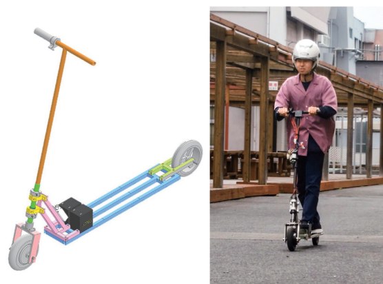
図2. 設計及び製作した電動キックボード
